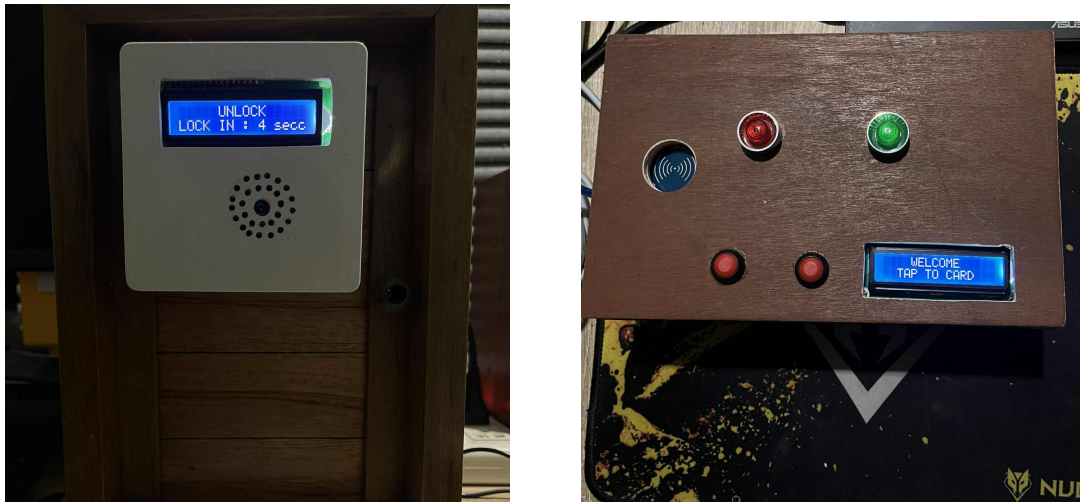
ภาพที่ 8 ติดตั้งระบบลงบนชิ้นงานประตูกำลึงและกล่องไฟจำลองในการควบคุมเปิด-ปิดไฟด้วย RFID
