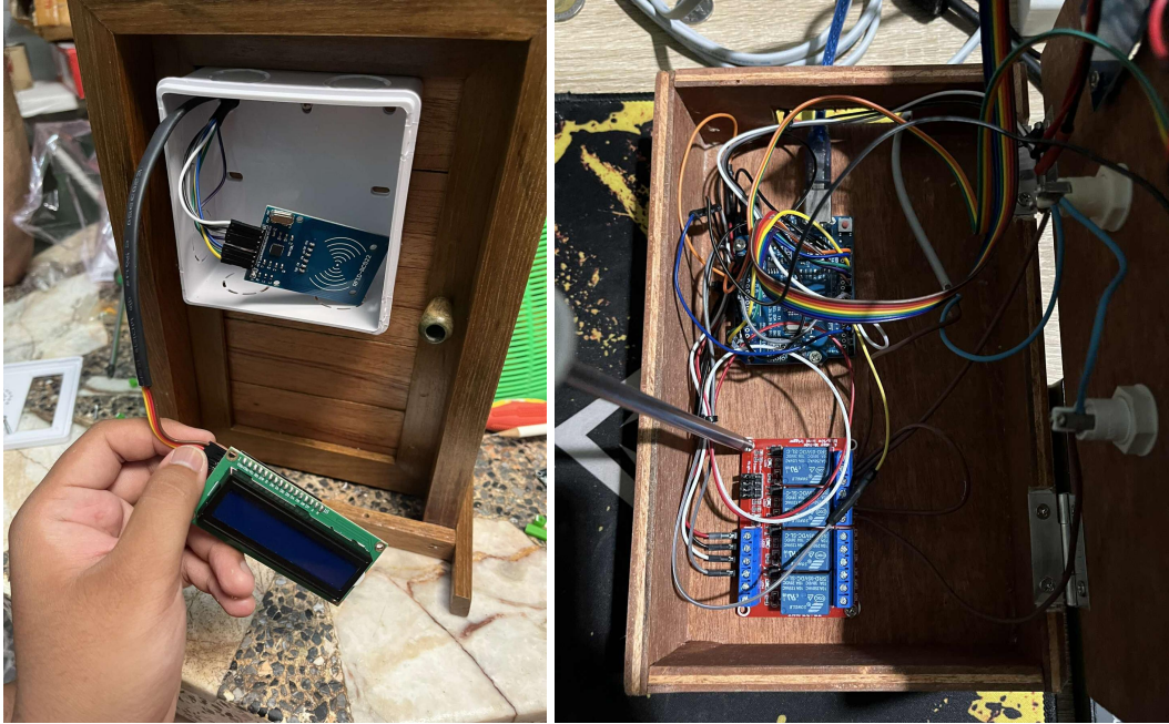
ภาพที่ 7 ติดตั้งระบบลงบนชิ้นงานประตูกำลึงและกล่องไฟจำลองในการควบคุมเปิด-ปิดไฟด้วย RFID
