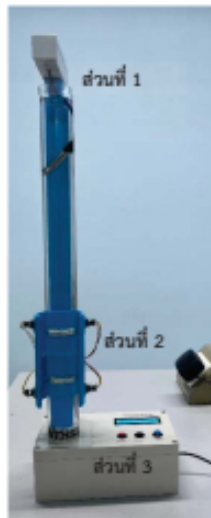
รูปที่ 1 ชุดต้นแบบราคาประหยัดเครื่องวัดค่าความหนืดของเหลวที่อุณหภูมิต่างๆ
