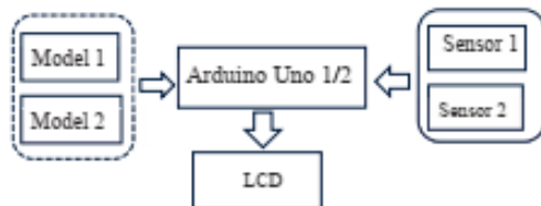
รูปที่ 2 งาน Block Diagram of Low-Cost Viscosity Laboratory
