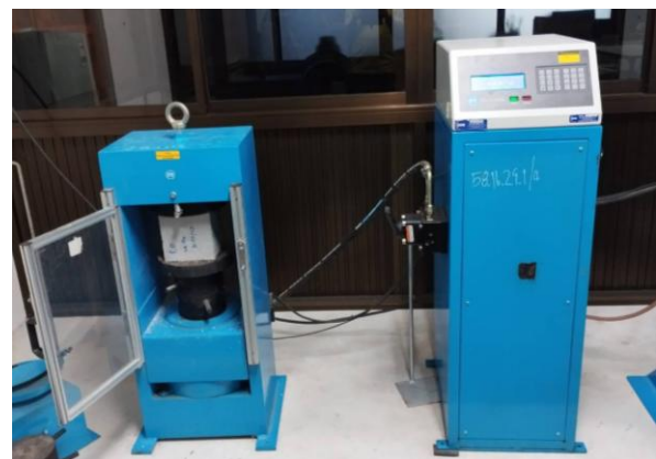
ภาพที่ 8 การทดสอบกำลังอัดคอนกรีตมวลเบา
