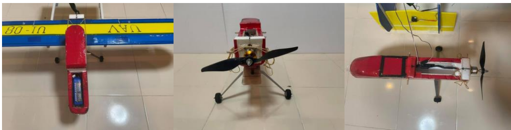
รูปที่ 13 การติดตั้งอุปกรณ์ชุดไฟฟ้า อุปกรณ์ควบคุม และระบบขับเคลื่อน
