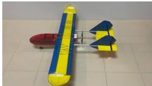
รูปที่ 11 ลักษณะการประกอบลำตัวเข้ากับปีกและชุดพวงหาง
