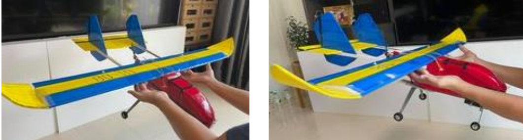
รูปที่ 12 ลักษณะการหาดำแหน่งจุดศูนย์ถ่วง (Center of Gravity: CG)
