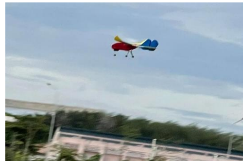
รูปที่ 14 การทดสอบและปรับปรุงอากาศยานไร้คนขับชนิดปีกตรึงแบบสองหาง
