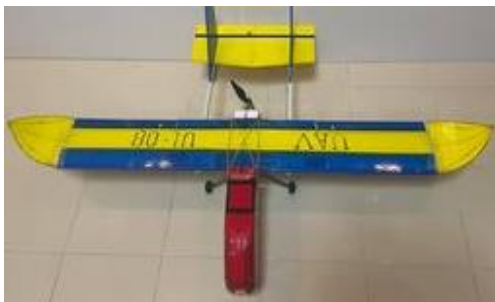
รูปที่ 11 ลักษณะการประกอบลำตัวเข้ากับปีกและชุดพวงหาง
