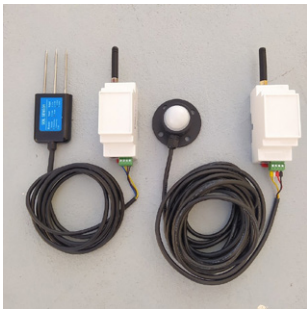
การต่อเซ็นเซอร์ภายนอกแบบ I2C และ การใช้งานเซ็นเซอร์โหนด กับเกตเวย์ LoRa มาตรฐาน
