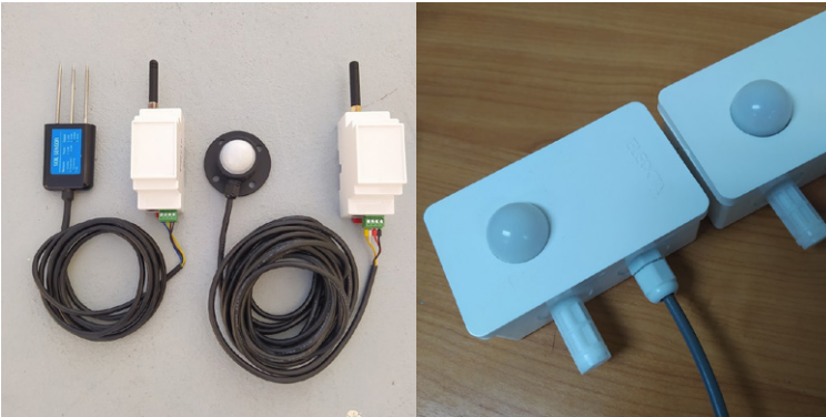
ตัวอย่างเซ็นเซอร์ชนิดที่เป็นแบบ LoRa และ ESP-NOW ที่ทำงานกับเกตเวย์
