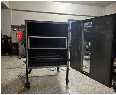
รูปที่ 3 ภายในเครื่องเผาข้าวหลามและวงจรควบคุมการทำงาน
