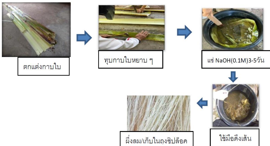
ภาพที่ 2 การสกัดเส้นใยกล้วยด้วยเบสแก่
