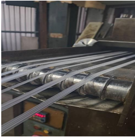
ภาพที่ 2 ภาพการปรับปรุงจำนวนช่องว่างตัวนำเส้นใยโพลีเมอร์
