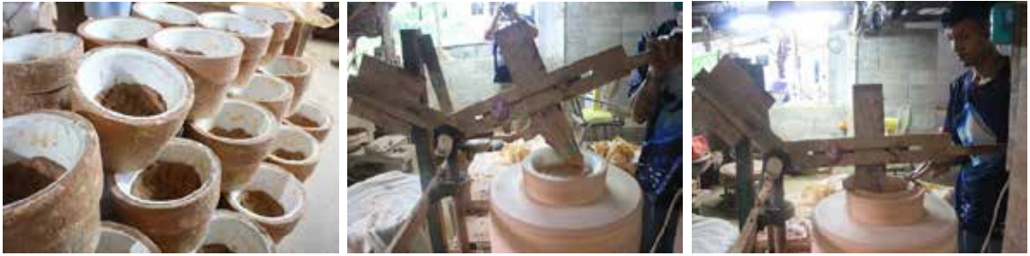
ภาพที่ 2 วิธีการขึ้นรูปด้วยแม่พิมพ์จี้กเกอร์
