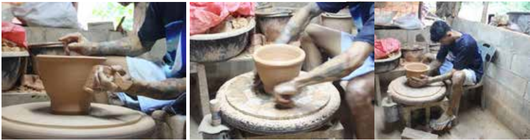
ภาพที่ 3 วิธีการขึ้นรูปแป้นหมุนเพื่อให้ได้รูปทรงตามที่ต้องการ
