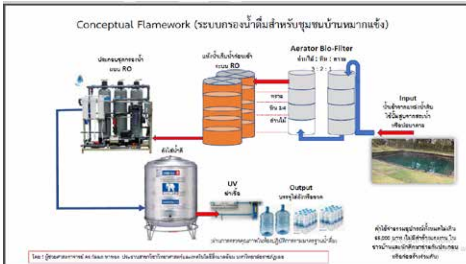
ภาพที่ 1 ระบบกรองน้ำดื่มชุมชนบ้านหมากแข้ง
