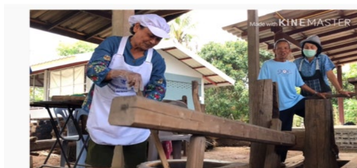
ภาพที่ 3 การตำน้ำพริกถั่วเน่ายังคงใช้เครื่องมือซึ่งเรียกว่า “ครกมองโบราณ”
