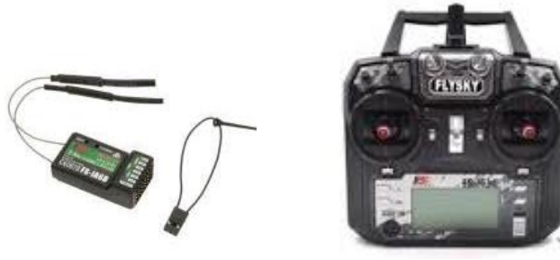
รูปที่ 14 รีโมทบังคับวิทยุ FLYSKY FS-i6X และตัวรับสัญญาณ FLYSKY 2.4G 6CH FS-iA6B
