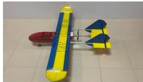
รูปที่ 12 ลักษณะการประกอบลำตัวเข้ากับปีกและชุดพวงหาง
