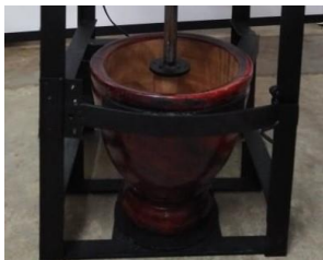
ภาพที่ 7 ชุดสากไม้และครกไม้เครื่องเตรียมสีต้นแบบ(เครื่องตำเปลือก)
