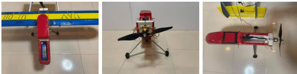
รูปที่ 15 การติดตั้งอุปกรณ์ชุดไฟฟ้า อุปกรณ์ควบคุม และระบบขับเคลื่อน
