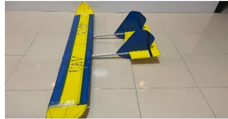
รูปที่ 10 ลักษณะการประกอบปีกเชื่อมกับชุดพวงหาง
