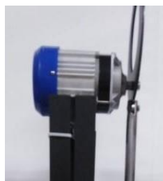
ภาพที่ 6 มอเตอร์ต้นกำลังเครื่องเตรียมสีต้นแบบ(เครื่องตำเปลือก)
