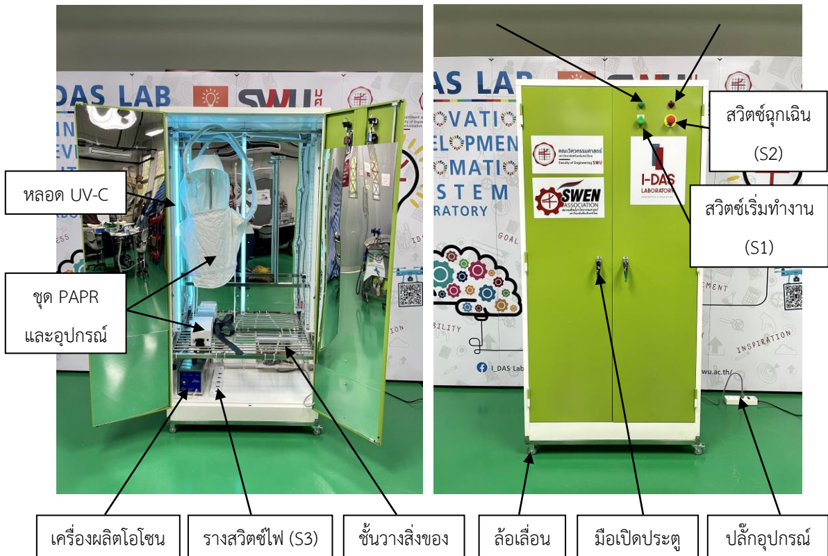
รูปที่ 2 ต้นแบบของตู้กำจัดเชื้อ COVID-19 ด้วยระบบโอโซนและยูวี-ซี
