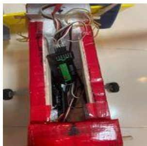
รูปที่ 11 ลักษณะการประกอบชุดไฟฟ้าและชุดควบคุม
