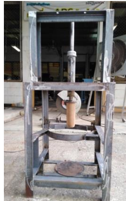
ภาพที่ 4 โครงสร้างของเครื่องเตรียมสีต้นแบบ(เครื่องตำเปลือก)
