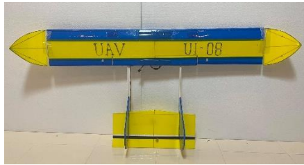
รูปที่ 10 ลักษณะการประกอบปีกเชื่อมกับชุดพวงหาง
