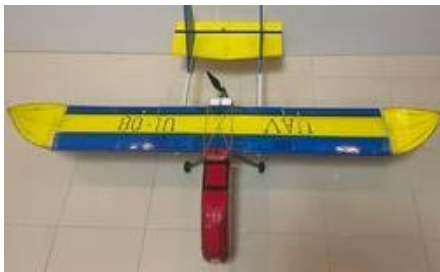
รูปที่ 12 ลักษณะการประกอบลำตัวเข้ากับปีกและชุดพวงหาง
