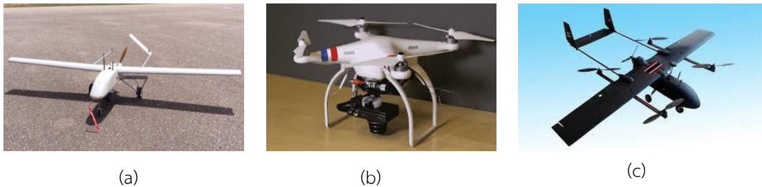
รูปที่ 1 อากาศยานไร้คนขับ a) ชนิดปีกตรึง (Fixed Wing) b) ชนิดปีกหมุน (Multirotor) และ c) ชนิดปีกตรึงขึ้นลงแนวดิ่ง (Fixed-Wing Hybrid)
