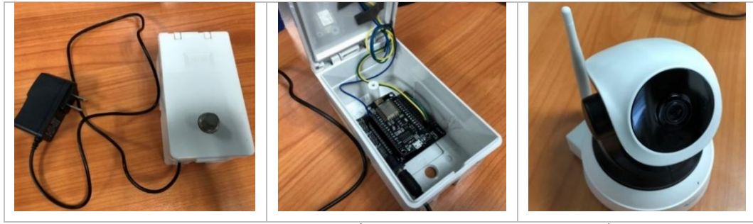
ภาพที่ 3: อุปกรณ์ที่ใช้สำหรับแจ้งเตือนการสูบบุหรี่
