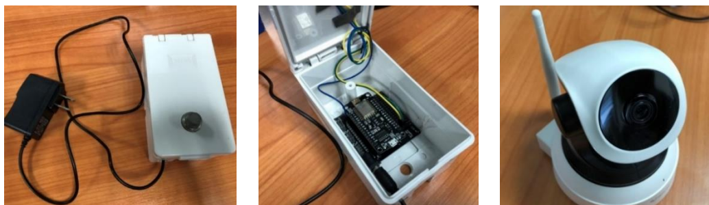
ภาพที่ 3 อุปกรณ์ที่ใช้สำหรับแจ้งเตือนการสูบบุหรี่
