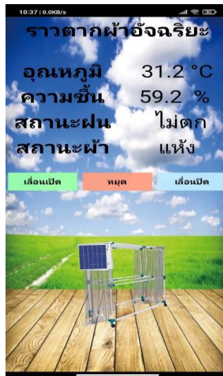
ภาพที่ 8 การทำงานของแอปพลิเคชันตรวจอุณหภูมิและความชื้นจากราวตากผ้าอัจฉริยะ
