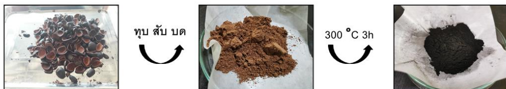
ภาพที่ 1 แสดงขั้นตอนการเตรียมวัตถุดิบสำหรับการสังเคราะห์ถ่านกัมมันต์
