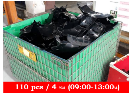
ภาพที่ 3 ระยะเวลาที่ใช้และของเสียที่เกิดขึ้นในระหว่างการทดสอบแม่พิมพ์
