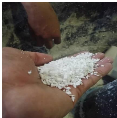
ภาพที่ 1 อีพีเอสโฟมที่ใช้แล้วและการย่อยให้ละเอียด
