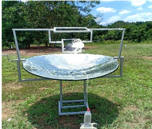
ภาพที่ 2 เครื่องกลั่นน้ำพลังงานแสงอาทิตย์จากจานรับแสงพาราโบลา
