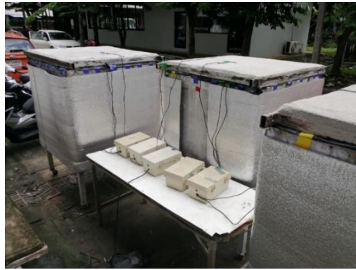
ภาพที่ 5 การติดตั้งเครื่องเก็บข้อมูลอัตโนมัติ สายวัดอุณหภูมิและความเข้มของแสงอาทิตย์
