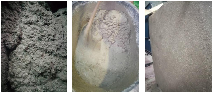
ภาพที่ 6 ตัวอย่างลักษณะปูนฉาบผสมอีพีเอสโฟมที่สร้างขึ้นในงานวิจัย
