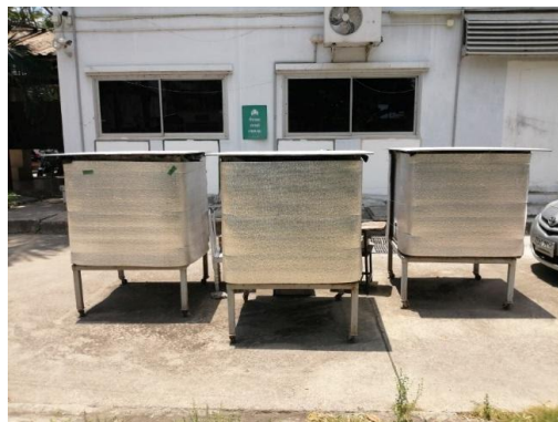
ภาพที่ 4 การสร้างห้องตัวอย่างจำลองสำหรับทดสอบอิฐบล็อกและปูนฉาบที่ผสมอีพีเอสโฟมที่ใช้แล้ว
