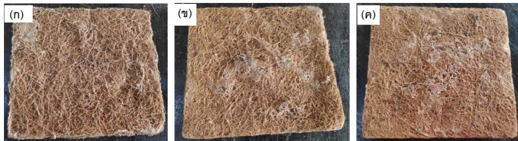
ภาพที่ 1 แสดงจนจนกว่าความร้อนจากวัสดุผสมระหว่างเส้นใยมะพร้าวกับน้ำยางพารา (ก) อัตราส่วน 10:90 โดยน้ำหนัก (ข) อัตราส่วน 20:80 โดยน้ำหนัก (ค) อัตราส่วน 30:70 โดยน้ำหนัก
