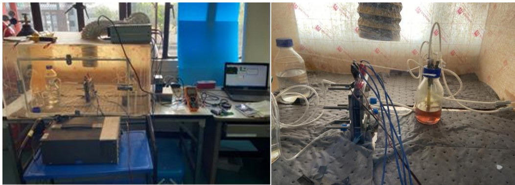
ภาพที่4: ชุดทดสอบสมรรถนะการทำงานของเซลล์เชื้อเพลิง
