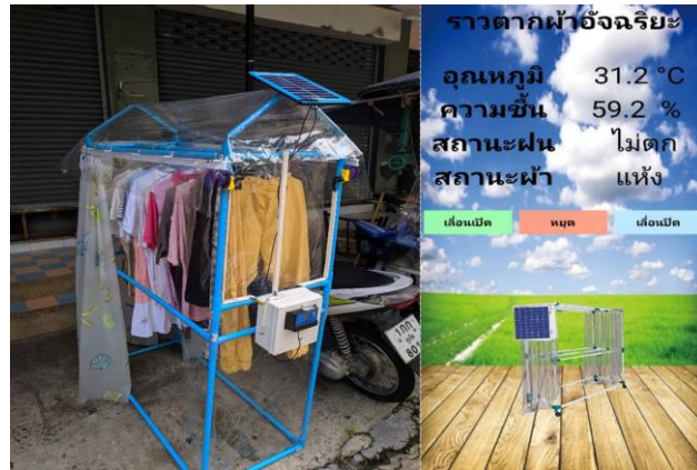
ภาพที่ 10 การวัดค่าความชื้นจากผ้าที่ตากและแสดงสถานะที่แอปพลิเคชัน
