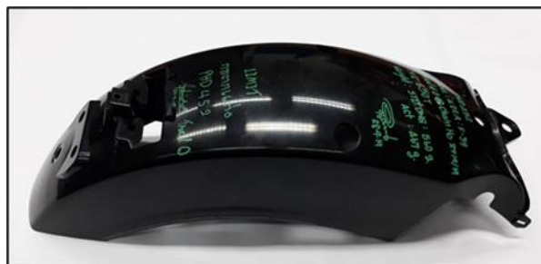
ภาพที่ 2 ลักษณะตัวอย่างของชิ้นงานบังโคลนหลังของรถจักรยานยนต์ PHD452
