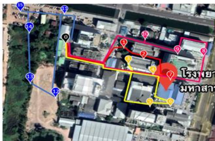
ภาพที่ 5 การจัดเส้นทางด้วย VRP Spreadsheet Solver กรณีรถขนขยะ 4 คัน
