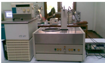
ภาพที่ 3 เครื่อง Bomb Calorimeter ที่ใช้หาค่าความร้อนสูงของชีวมวล
