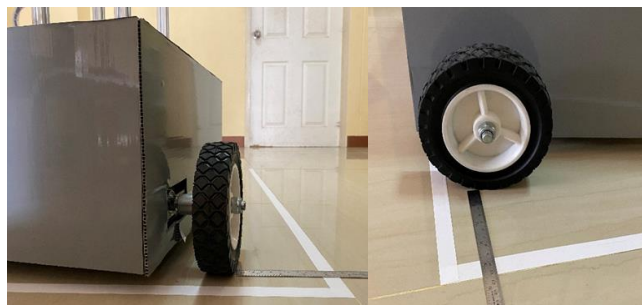
ภาพที่ 4 การวัดระยะคลาดเคลื่อนในการเคลื่อนที่ของหุ่นยนต์
