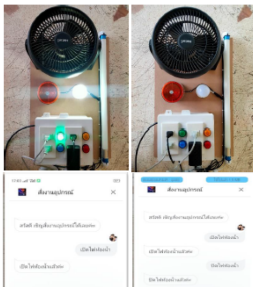
ภาพที่ 10 ตัวอย่างผลลัพธ์การทำงานของระบบเปิด-ปิดไฟและเครื่องใช้ไฟฟ้าด้วยคำสั่งเสียงผ่านแอปพลิเคชัน (หลอดไฟแอลอีดี แสดงความหมาย “ไฟห้องน้ำ”)
