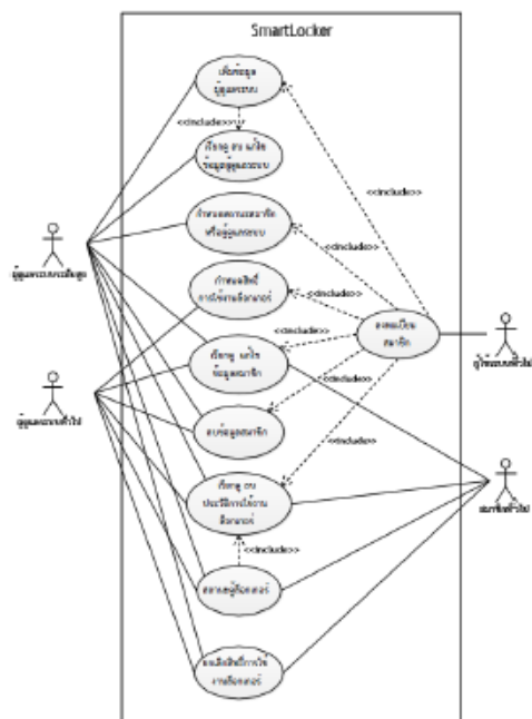
ภาพที่ 3 Use Case Diagram ระบบตู้ล็อกเกอร์อัจฉริยะควบคุมผ่านแอปพลิเคชัน
