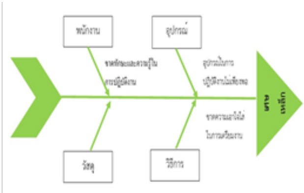
ภาพที่ 3 แผนผังก้างปลา แสดงสาเหตุของการเกิดของเสียจากกระบวนการประกอบโต๊ะล้อ
