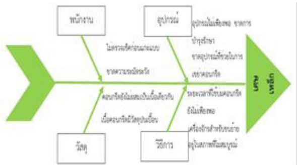
ภาพที่ 4 แผนผังก้างปลาแสดงสาเหตุของการเกิดของเสียที่เกิดจากกระบวนการแกะแบบและเก็บเข้าคลังสินค้า
