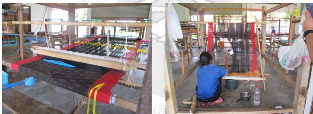
ภาพประกอบชุดที่ 2 กี่ทอผ้าแบบโบราณ และเครื่องคันด้าย (ไหม) แบบโบราณ
