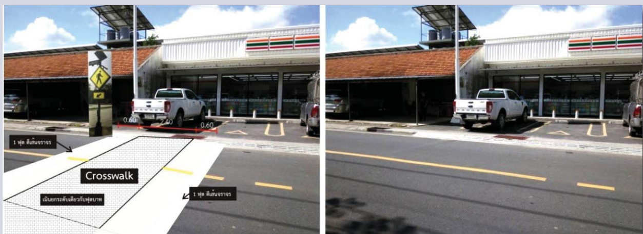
ภาพที่ 10 ผลงานการออกแบบทางข้ามบริเวณหน้าโรงพยาบาลกลาง ตามข้อมูลการวิเคราะห์พื้นที่จุดเสี่ยง
