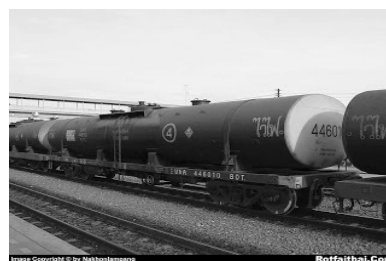
รูปที่ 1 รถโบกี้บรรทุกน้ำมันขึ้น(บคท.) ขนาด 25 ตัน (รถไฟไทย, 2561)
