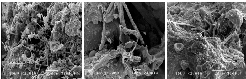
ภาพที่ 1 ภาพถ่ายภายใต้กล้องจุลทรรศน์อิเล็กตรอนแบบส่องกราดของตัวอย่างอิฐซึ่งเป็นวัสดุก่อสร้างของโบราณสถานในอุทยานประวัติศาสตร์พระนครศรีอยุธยา (1) ตัวอย่างอิฐจากวัดมหาธาตุ (2) ตัวอย่างอิฐจากวัดวัดราชบูรณะ (3) ตัวอย่างอิฐจากวัดพระราม
