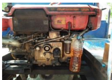
ภาพที่ 7 ทดสอบกับเครื่องยนต์การเกษตรเครื่องยนต์ดีเซลรุ่น RT 110 ขนาด 11 แรงม้า
