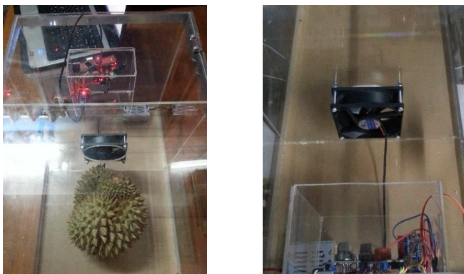
ภาพที่ 1 แสดงกล่องสำหรับวัดระดับการสุกของผลไม้
