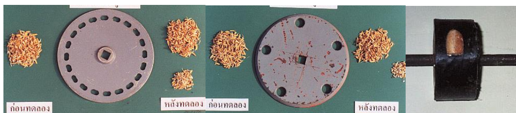
ภาพที่ 2 (ก) จานหยอดเมล็ดแบบรูรี (ข) จานหยอดเมล็ดแบบรูกลมและ (ค) ลูกกวักแบบร่องโค้ง
