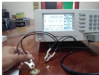
ภาพที่ 4 การวัดค่าความต้านทานและค่าการเก็บประจุของเพียโซอิเล็กทริก
