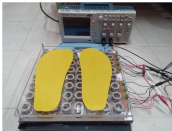
ภาพที่ 3 การต่อโมดูลเพียโซอิเล็กทริกเพื่อวัดรูปคลื่น
