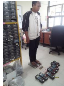
ภาพที่ 3 การต่อโมดูลเพียโซอิเล็กทริกเพื่อวัดรูปคลื่น
