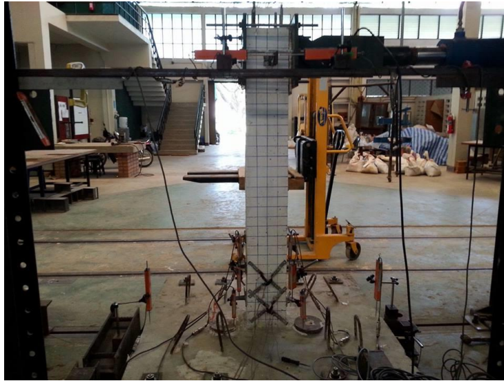
ภาพที่ 4 การติดตั้งตัวอย่างทดสอบในห้องปฏิบัติการ
